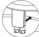
Ajuste la posición del cuerpo principal de manera que las boquillas queden al menos a 3 mm del borde del inodoro.
