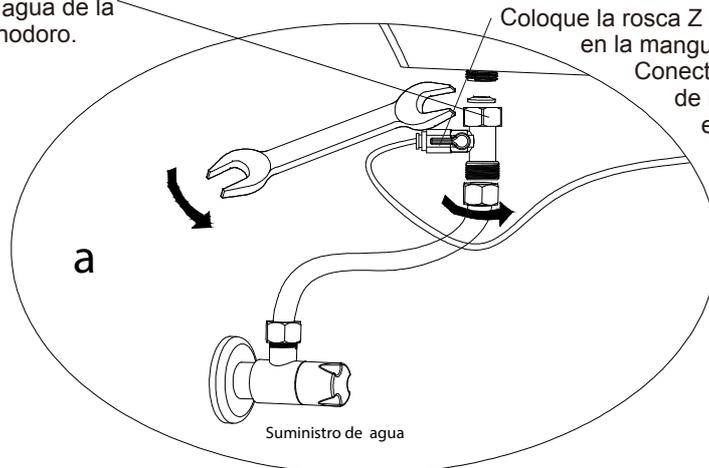
Coloque la rosca Z (ver pág. 1) en la manguera provista. Conecte el extremo de la manguera en el pico del Adaptador-T y ajuste la rosca Z.
