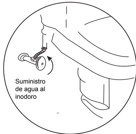
Cierre la válvula de suministro de agua del baño. Vacíe el depósito del inodoro.
